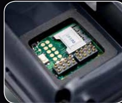
Speicher: 256 MB RAM / 256 MB Flash mit MicroSD Speichererweiterung
