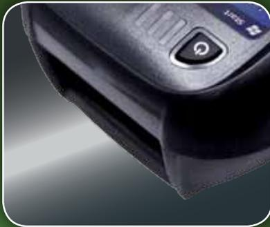
Verstärkte Polykarbonat Struktur hält wiederholtem Fall aus 1,8 m Höhe stand
