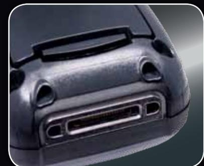
Geräteschnittstelle mit sicherer Verbindung zu seriellen und USB-Anschlüssen oder Audioausgängen
