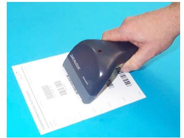
Avec les lecteurs Touch™ Light, la lecture des codes s'effectue automatiquement et par contact. Tous les modèles sont doués d'un poussoir qui doit par défaut être appuyé pour lire le code. Après avoir configuré l'interface de lecture, on peut sélectionner le paramètre software trigger (disponible dans ce manuel) pour utiliser le lecteur comme un modèle sans poussoir.
