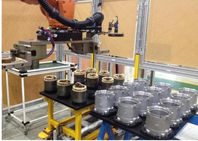
电机是新能源汽车电驱的核心之一，随着新能源汽车的普及，新能源电机的需求量也呈现稳步上升的态势。在新能源汽车企业的电机自动装配中，检测的要点是需要保证视觉系统精确地识别定子和电机壳的位置，
