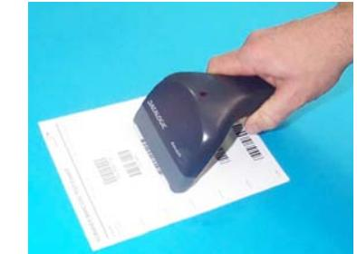
I lettori CCD Touch™ leggono i codici a barre automaticamente e a contatto. Tutti i modelli sono dotati di pulsante che per default deve essere premuto per effettuare la lettura. Dopo aver effettuato la configurazione dell'interfaccia, il parametro "software trigger" (disponibile in questo manuale) può essere selezionato per far funzionare il lettore come un modello senza trigger.
