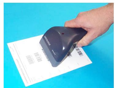
I lettori CCD Touch™ Light leggono i codici a barre automaticamente e a contatto. Tutti i modelli sono dotati di pulsante che per default deve essere premuto per effettuare la lettura. Dopo aver effettuato la configurazione dell'interfaccia, il parametro "software trigger" (disponibile in questo manuale) può essere selezionato per far funzionare il lettore come un modello senza trigger.
