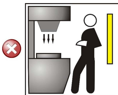
Figura 3 - Posicionamiento incorrecto de la barrera
